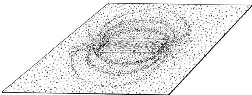
*Рис. 2.6. Силовые линии магнитного поля вокруг магнитного бруска видны благодаря рассыпанным по листу бумаги железным опилкам (Рисунок Мэтта Зимета по моему наброску; из моей книги «Черные дыры и складки времени: дерзкое наследие Эйнштейна» [Торн 2009].)*
