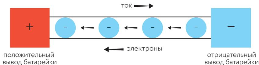
\* Электроны — отрицательно заряженные частицы, но в некоторых веществах ток могут переносить частицы с положительным зарядом. Поэтому на атомном уровне частицы могут двигаться в обоих направлениях.
