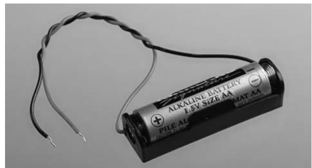
Рис. 1.9. Отсек-держатель с проводами для одной 1,5-вольтовой батареи типа AA
