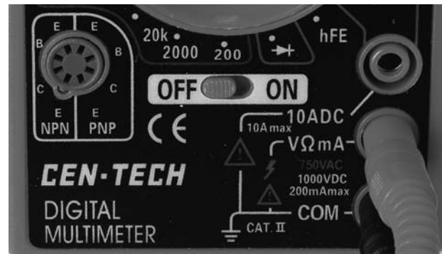
Рис. 1.19. На этом мультиметре функции гнезд разделены
