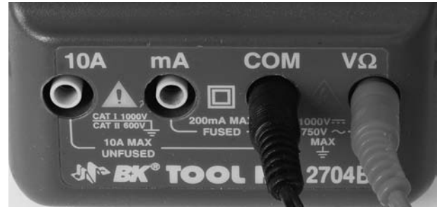
Рис. 1.18. Обратите внимание на маркировку гнезд этого мультиметра
