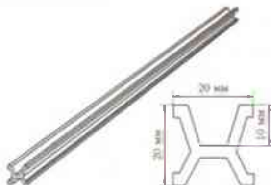
Рис. 14. Первоначальный эталон метра (общий вид и сечение)
