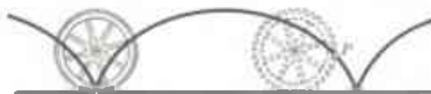
Рис. 5. Точка P на ободке катящегося колеса описывает относительно земной поверхности траекторию, изображенную на рисунке (циклоиду)
