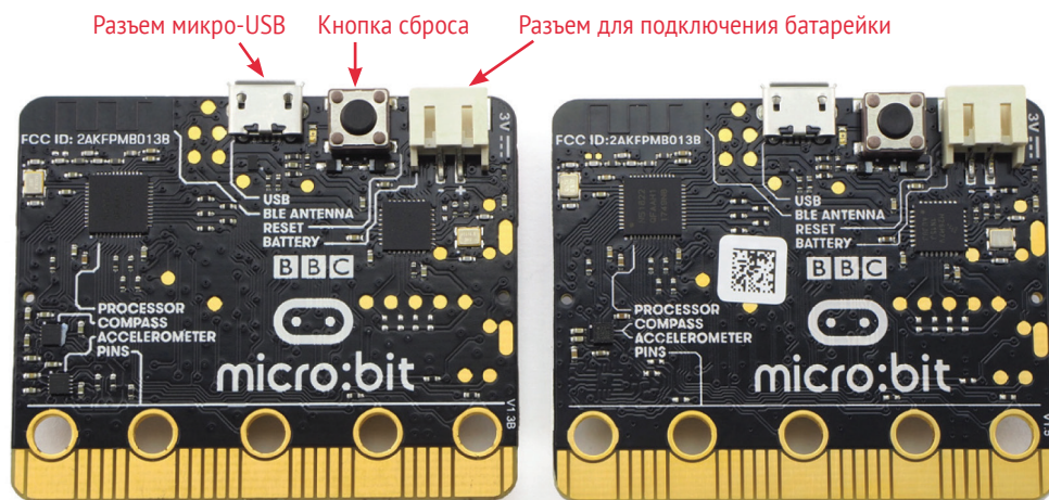
Рис. 1.2. Обратная сторона платы micro:bit , версий 1.3В (слева) и 1.5 (справа)
