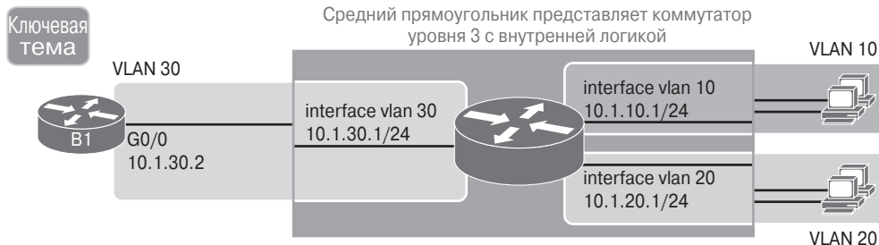
Рис. 18.13. Маршрутизация на интерфейсах VLAN коммутатора уровня 3
