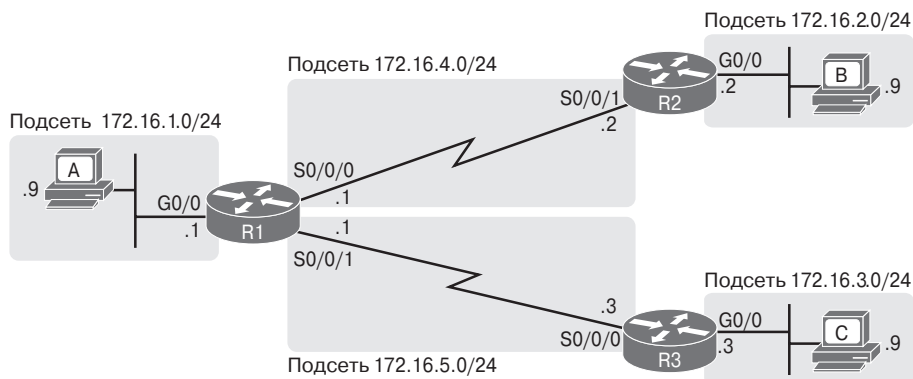
Рис. 18.3. Сеть IPv4, используемая в примере с пятью этапами маршрутизации
