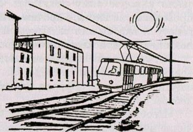
Рис. 73. Изгибание трамвайных рельсов вследствие сильного нагревания
